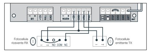
Quando le fotocellule sono alimentate, all'interno di ognuna di esse è accesa una spia rossa. Quando le fotocellule sono allineate, all'interno della fotocellula RX è accesa una sola spia rossa. Se le fotocellule non sono allineate, una seconda spia si accende all'interno della fotocellula RX.
