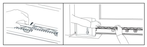
Controllare che tutta la cremagliera sia centrata sulla ruota dentata del motore. In caso contrario, regolare la posizione del motore sulla base.
