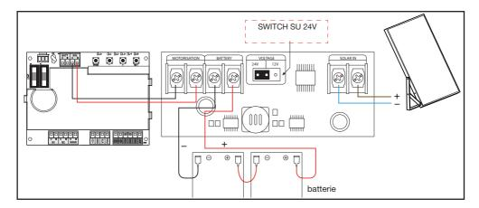
Attenzione a rispettare la polarità e ad attenersi scrupolosamente allo schema di collegamento. In caso di dubbi, fare riferimento al manuale del kit di alimentazione a energia solare.
