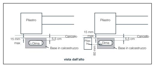
I cavi devono essere installati in conformità alle norme vigenti (per la Francia, NFC 15-100). O il cavo viene fatto passare a 80cm di profondità con griglia di segnalazione rossa, oppure viene inserito in un corrugato. Disporre la guaina per il passaggio dei cavi e i piedi per il fissaggio a terra come indicato sullo schema sequente prima di procedere con la colata di calcestruzzo.
