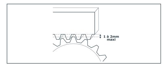
Fissare la cremagliera con le rondelle e le viti fornite. Continuare ad aprire leggermente il cancello per fissare la terza piastra della cremagliera.
