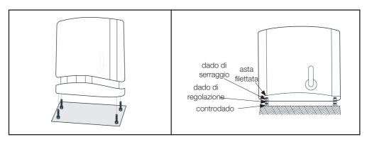
Dopo aver controllato che il motore sia perfettamente orizzontale, stringere i controdadi per bloccare il dado di serraggio, quindi stringere i dadi di serraggio per bloccare il motore.
