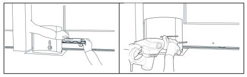
La cremagliera deve essere perfettamente orizzontale; ove necessario, servirsi di una livella. Lasciare una distanza di 1 - 2 mm massimo tra la cremagliera e la ruota dentata del motoriduttore.
