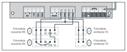
Protezione bordi primari e secondari: nel caso precedente, la seconda coppia non può essere montata per proteggere il bordo secondario del cancello durante l'apertura. Per questo tipo di operazione, collegare la seconda coppia di fotocellule all'ingresso "arresto di emergenza" come mostrato di seguito:
