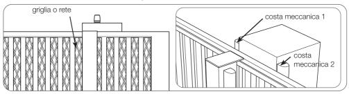
La costa meccanica 2 è obbligatoria se il pilastro e il muretto (o il recinto) non sono allineati (v. schema) e si viene a creare una zona di schiacciamento tra il bordo del pilastro e le sbarre del cancello. Le coste meccaniche utilizzate devono possedere una deformazione sufficiente tra l'attivazione e la posizione in cui il cancello si ferma (circa 6 cm) (corsa residua come da fig. 3, ai sensi di EN 12978).
