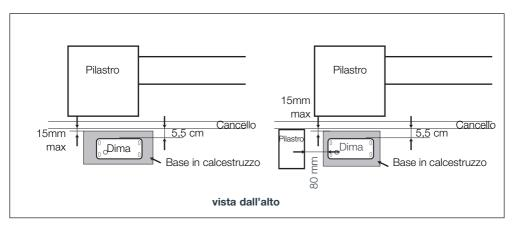
I cavi devono essere installati in conformità alle norme vigenti (per la Francia, NFC 15-100). O il cavo viene fatto passare a 80cm di profondità con griglia di segnalazione rossa, oppure viene inserito in un corrugato. Disporre la guaina per il passaggio dei cavi e i piedi per il fissaggio a terra come indicato sullo schema seguente prima di procedere con la colata di calcestruzzo.
