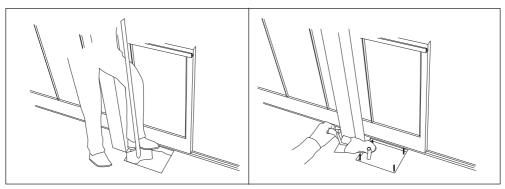
I piedi devono corrispondere alla dima di posizionamento in dotazione. Prima di montare il motore, attendere che la base sia completamente asciutta.
