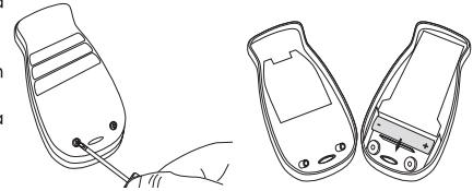
**NL- Plaatsing of vervanging van de batterij van de afstandbediening**
