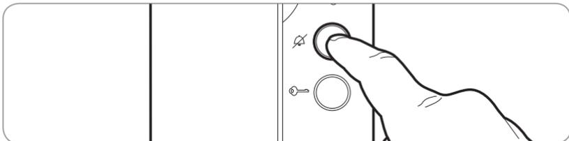
**Attention** : Ne pas appuyer trop longtemps sur le bouton de commande de gâche pour éviter la détérioration de la platine de rue.
