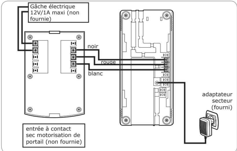
Il est également possible de commander l'ouverture d'un portail électrique depuis le combiné interne avec le bouton de commande de gâche. Attention cependant à vérifier que l'entrée de commande sur la motorisation tolère une tension +12V sinon il faudra utiliser un relais. Pour plus de renseignements se référer à la notice de la motorisation.
