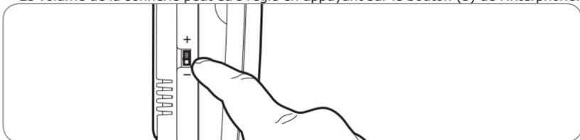
L'appui sur le bouton de commande (4) de l'interphone envoie une impulsion électrique qui déverrouille la porte sur laquelle la gâche électrique est montée.
